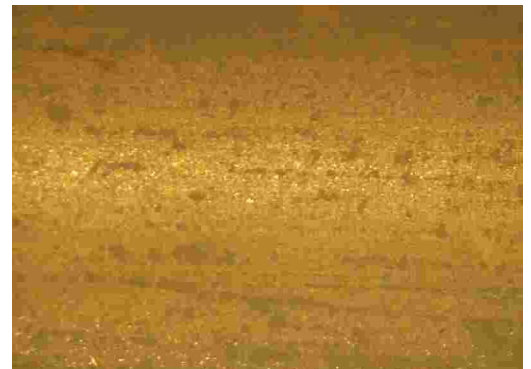
Figuur 8: Microscop foto buissegment N4 na waterontharder; dunne roodbruine laag vergroting 10x.
