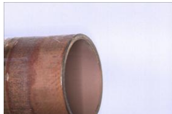
Figuur 6: Buissegment N4 uitstroomzijde passieve laag is roodbruin.
