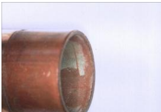
Figuur 5: Buissegment V4 uitstroomzijde passieve laag is roodbruin en groen.
